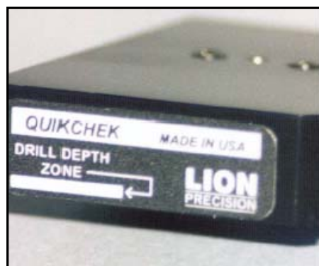
在測試之前, 依標籤上的指示可快速地設定適當的下刀深度。
