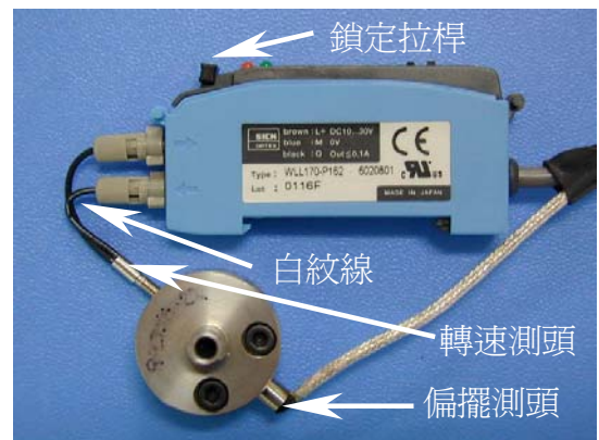
QuikChek 內之轉速及偏擺測頭與安裝座總成,其中鎖定拉桿顯示在鎖定位置。
